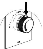
Press the security button and turn the handle counterclockwise until stopped. Appuyez sur le bouton de sécurité et tournez la poignée dans le sens anti-horaire jusqu'à l'arrête.
