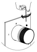
Tighten the set screw with the help of an allen key, securing the handle. Serrez la vis à l'aide d'une clé Allen, afin de fixer la poignée.
